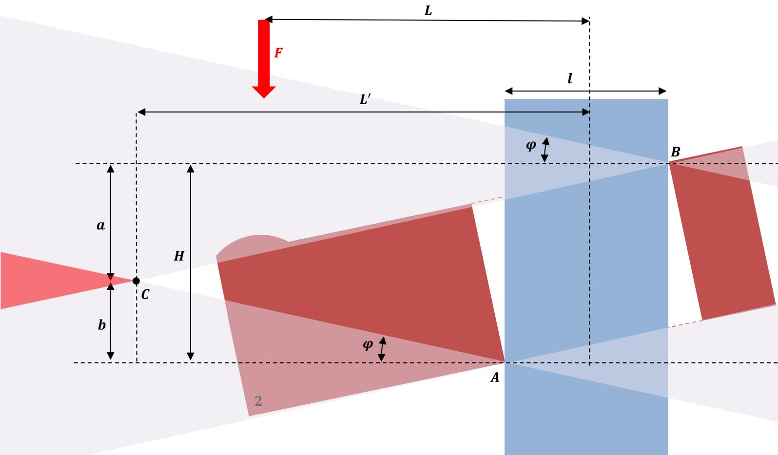
**Question 15:** Colorier la zone des points de concours possibles des 3 forces appliquées au solide 2 et justifier le fait que  $L'$  est une longueur minimum  $L_{min}$  permettant l'équilibre
