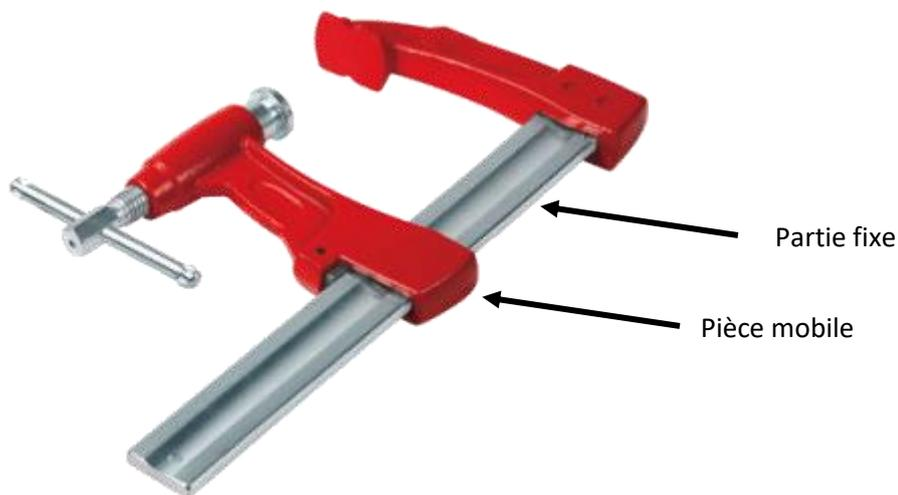
Le serre joint est un système mécanique composé de deux pièces en liaison glissière l'une par rapport à l'autre. Lorsque la pièce mobile ne serre pas d'objet, elle est libre en translation et on peut remarquer qu'il existe un jeu visible dans la liaison glissière avec la partie fixe. Par contre, lorsque le serre joint est utilisé pour serrer une pièce, la liaison glissière se transforme en une liaison encastrement.
