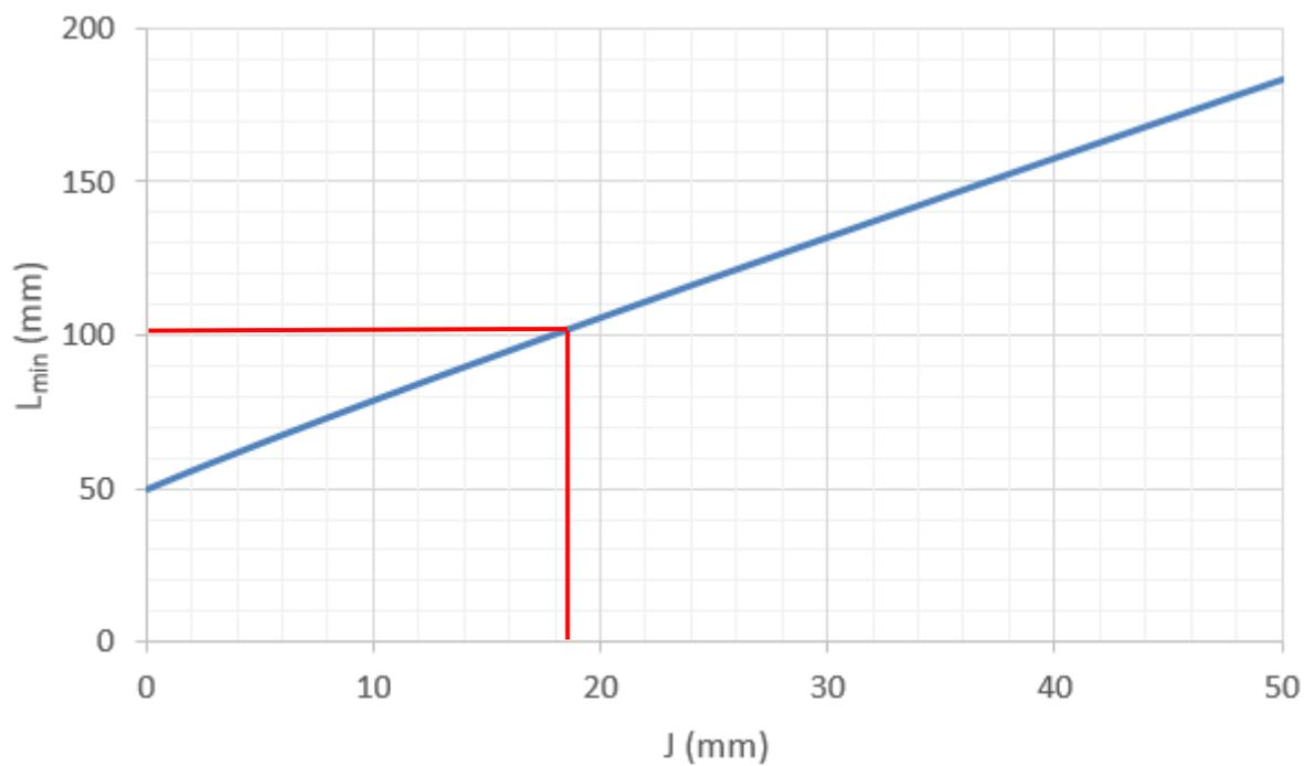
On voit que pour un jeu aux alentours de 18,22 mm, le serre joint ne fonctionnera plus.
